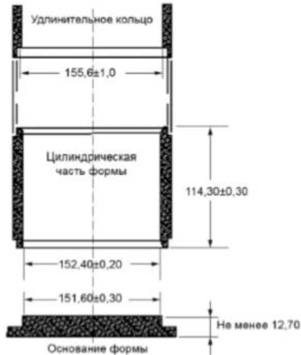
Рисунок А.2 – сборная форма для уплотнения образцов с максимальным размером 31,5 мм - устройство для извлечения образца (выжимное устройство), позволяющее извлечь образец из формы без повреждения - уплотнительный молот для уплотнения образцов со скользящим грузом, схема которого представлена на рисунке А.3. Технические характеристики молота в зависимости от крупности частиц уплотняемой смеси представлены в таблице А.1.
